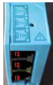
Датчик, подключенный к токовому входу 1, измеряет ток фазы 3 (V3)
