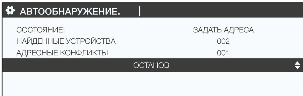
Чтобы перейти по этому адресу, найдите горящий светодиодный индикатор «COM» на передней панели каждого изделия. Нажмите и удерживайте эту кнопку в нажатом положении в течение нескольких секунд, пока светодиод не начнет мигать:
