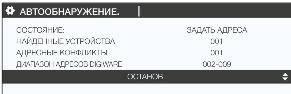
Чтобы перейти по этому адресу, найдите горящий светодиодный индикатор «COM» на передней панели каждого изделия. Нажмите и удерживайте эту кнопку в нажатом положении в течение нескольких секунд, пока светодиод не начнет мигать:
